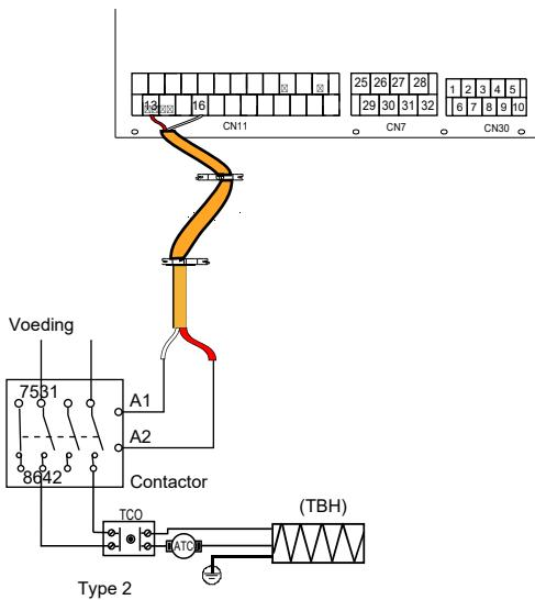
Controlesignaalpoort van hydraulische module: de CN11/CN7 bevat klemmen voor zonne-energie, 3-wegklep, pomp, boosterverwarming enz.
