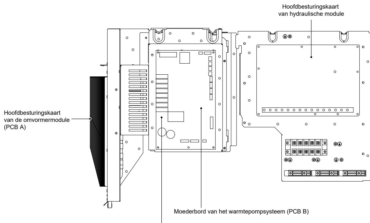
Filterbord (PCB C) (op de achterkant van het PCB B, alleen voor 3-fasige modellen)
