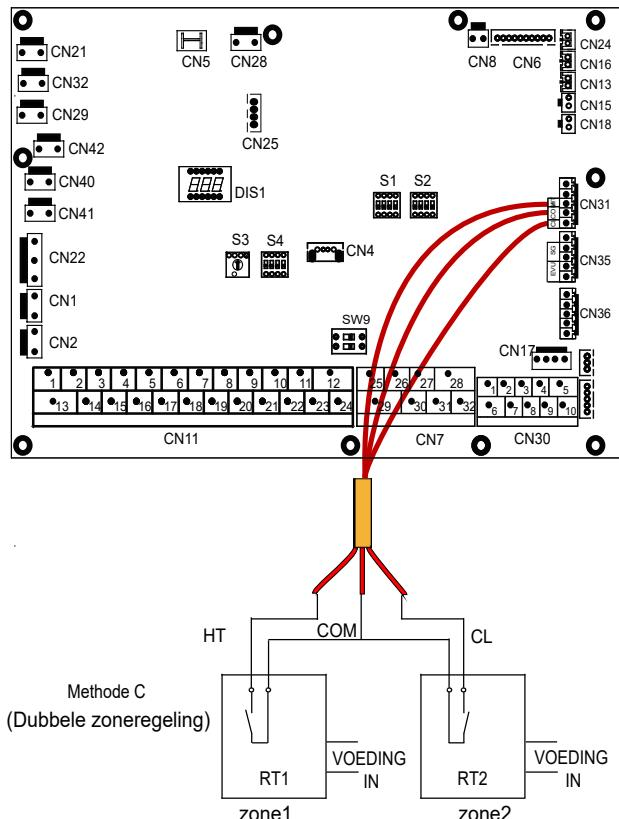
Er zijn afhankelijk van de toepassing 3 methoden om de thermostaatkabel aan te sluiten (zoals beschreven in de bovenstaande afbeelding).
